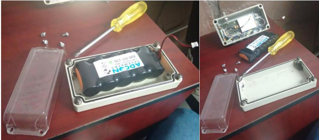
8. Posicionamos la nueva batería dentro del plástico acomodando bien el cable rojo-negro. El plástico tiene un lado especial para permitir la salida del cable sin maltratarlo.
