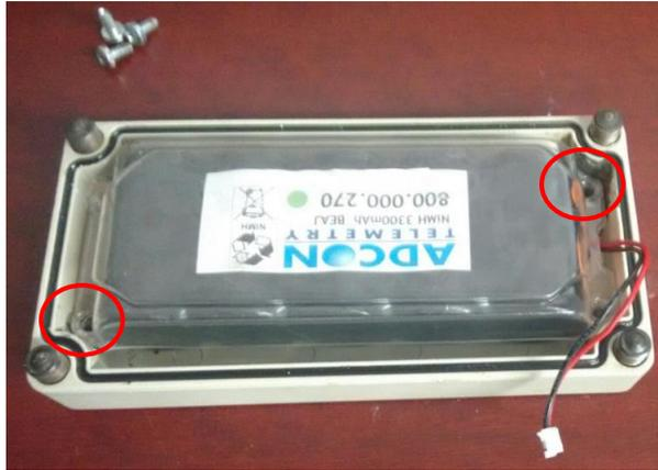
10. Una vez que la batería y el plástico están bien fijos en la tapa de la UTR cambiaremos el empaque (el hule negro que se observa en el contorno de la tapa). Sacamos el empaque y ponemos uno nuevo asegurándonos de que el lado curvo quede insertado en la ranura y el lado plano hacia arriba, deslizamos el dedo pulgar para garantizar que quede bien colocado.
