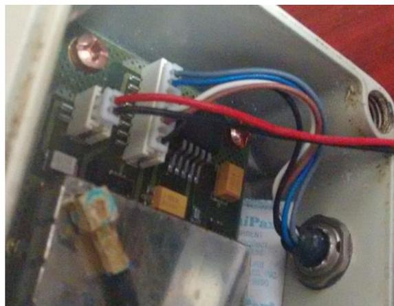
13. Una vez que: la batería nueva está bien fija en la tapa de la UTR y conectada, hemos puesto el empaque nuevo y la nueva bolsa repelente de humedad; cerramos la UTR con cuidado de que el cable no quede aplastado por la tapa y ajustamos los tornillos de forma diagonal con la llave Allen. La tapa de la UTR deberá quedar derecha, bien sellada, con los señalamientos de los puertos en la parte inferior como la vimos antes de removerla.
