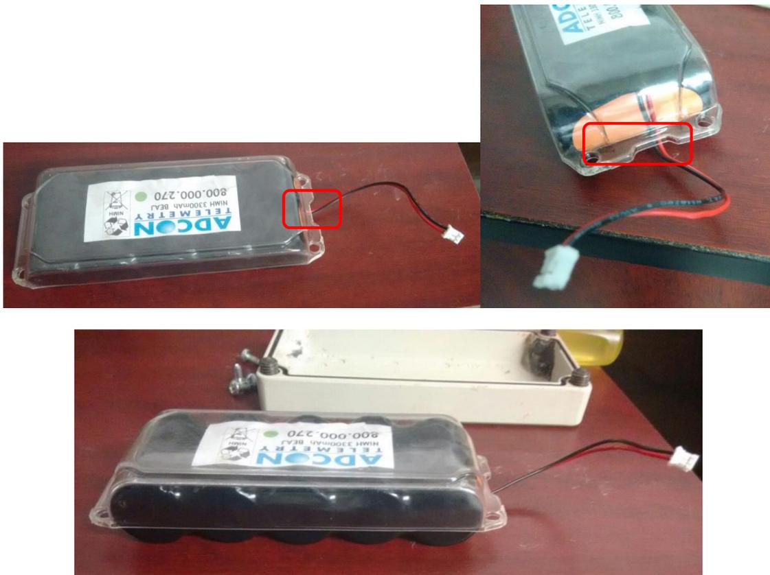
9. Colocamos la nueva batería con el plástico dentro de la tapa de la UTR y atornillamos por esquinas opuestas (no debemos hacerlo con demasiada fuerza porque podríamos fracturar el plástico).
