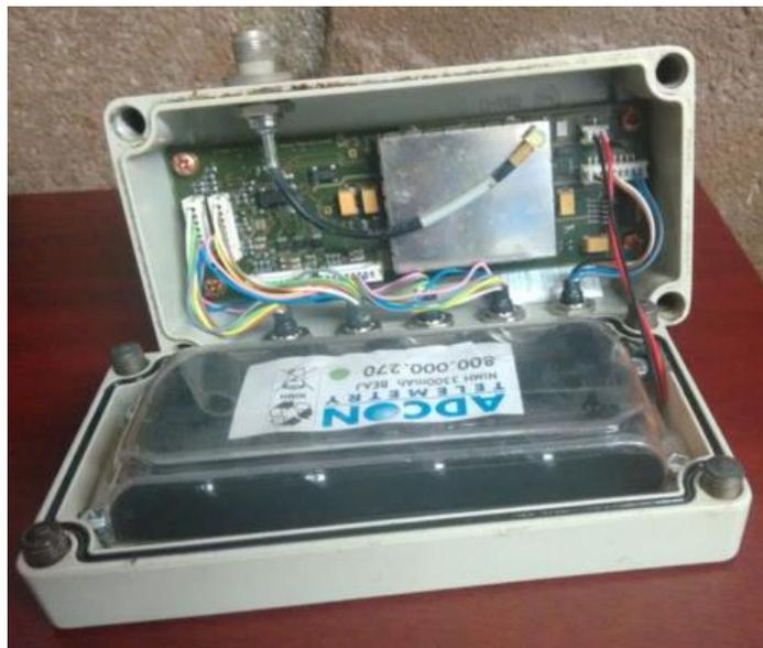
5. La batería está conectada a la UTR mediante dos cables (uno rojo y uno negro). A continuación sujetaremos los dos cables cerca de la terminal conectada a la UTR y jalaremos con cuidado para desconectar la batería y lograr que la tapa quede totalmente suelta.
