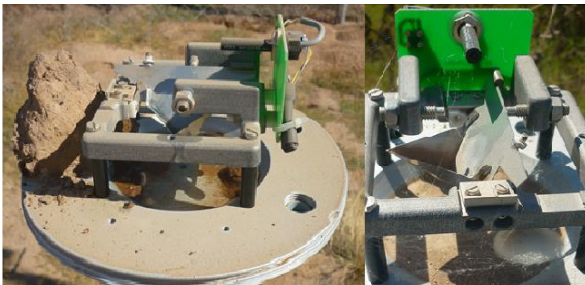
Figura 3. Fotografías del interior de dos pluviómetros que muestran la importancia de revisarlo y limpiarlo con frecuencia.
