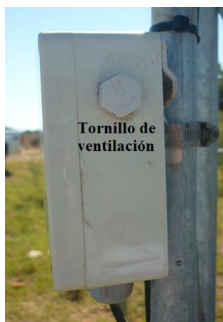
Figura 6. Fotografía del costado del sensor de presión barométrica donde se ilustra la ubicación del tornillo de ventilación.
