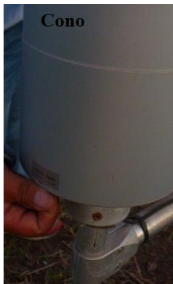
Figura 2. Fotografía que muestra como desajustar el cono del pluviómetro.
